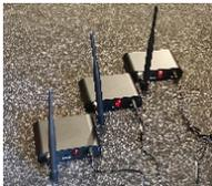
3 Kanäle, über 150 m Reichweite, Integrierter Akku mit 4 bis 5 Stunden Laufzeit
